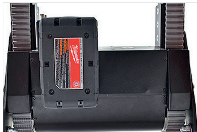
Sicher befestigter Akku am Motorgehäuse
