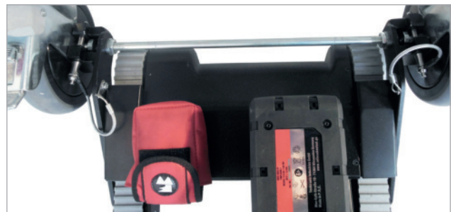
Abb. PT9 Untere Arretierbolzen durch Sicherungsbolzen gesichert
