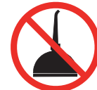
Verbotshinweis am Raupensystem. Raupensystem nicht schmieren.
