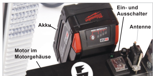
Motorgehäuse mit Akku, Antenne und Ein- und Ausschalter
