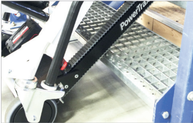
Für den Treppentransport aufwärts die Raupenschienen auf der untersten Treppenstufe aufliegen.
