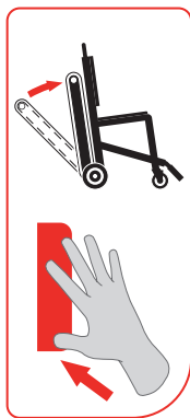
Bedienungshinweis auf dem Raupenschienenverriegelungshebel zum Schliessen des Raupensystems
