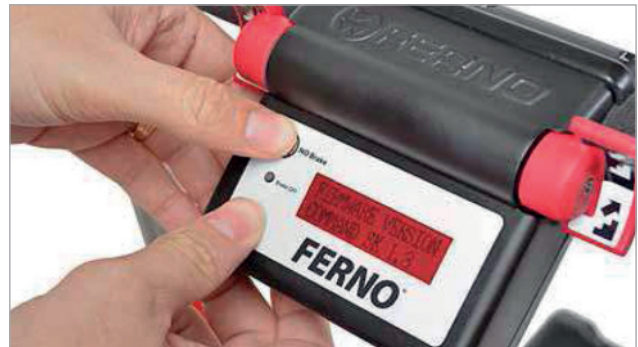
Funktionstaste (FW) und STOP-Taste „Nicht Bremsen“ gleichzeitig drücken
